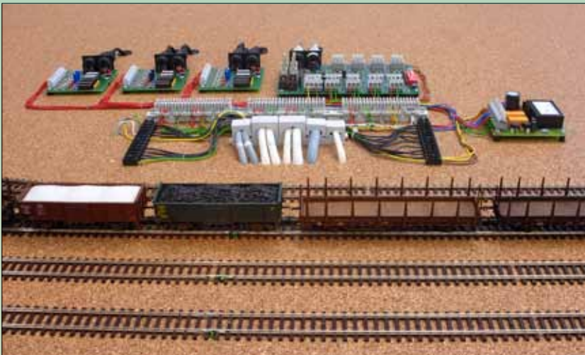
Die elektronischen Baugruppen im offenen Abstellbahnhof Cham. Die offene Anordnung erleichtert die Verdrahtungsarbeiten und sorgt für gute Zugänglichkeit.
